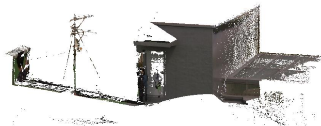
이미지 픽셀과 매칭되는 3D mesh에 해당 하는 점 군 추출 (이미지 기반 안전점검 데이터와 3차원 점 군 매칭)
