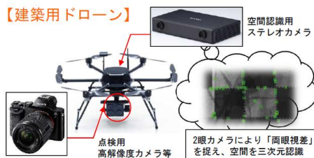
【建築用ドローン】
